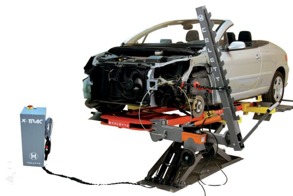
Réparation avec équerre Repair with pulling unit
